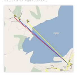
Zur Überwindung der Strecke von ca. 5,5 Kilometern von Hagenwerder (dem **DSL-Standort** nächstgelegenen mit Sichtverbindung) nach Jauernick-Buschbach wird ein gerichtetes WLAN-Signal im 5-GHz-Bereich genutzt. In Jauernick-Buschbach wird das gerichtete Funksig-
